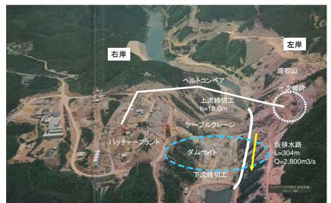
高山ダム施工計画配置図（昭和41年頃）
